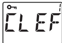
Taste und den Drehregler gleichzeitig 3 s lang drücken, bis **CLEF 1** und das Symbol angezeigt werden. Das Gerät ist gegen unerwünschten Zugriff auf die Einstellungen geschützt, nur der Ein-/Ausschalter kann betätigt und das Gebläse aktiviert werden.
