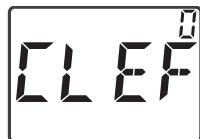
Taste und den Drehregler gleichzeitig 3 s lang drücken, bis **CLEF 0** angezeigt wird, das Symbol erlischt.
