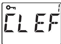
Appuyer simultanément sur la touche et le bouton rotatif de réglage pendant 3 s, jusqu'à ce que **CLEF 1** et le symbole s'affichent.
