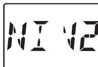
Tasten und 3 s lang drücken, bis **NIV2** angezeigt wird. Taste 3 s lang drücken, bis der erste Parameter angezeigt wird. Drehregler drücken, um zum nächsten Parameter weiterzuschalten und zum Schluss zum manuellen Betrieb zurückzukehren.
