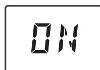
Appuyer simultanément sur les touches **V** et **Auto** pendant 3 s pour ouvrir le menu de programmation. Avec le bouton rotatif de réglage, sélectionner **ON**. Appuyer ensuite sur le bouton rotatif de réglage pour confirmer. **OFF** permet de quitter le menu.
