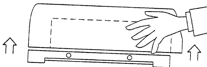
Der Händetrockner ist unter Beachtung nachfolgender Montagemaße und Mindestabstände an einer senkrechten Wand mit der Luftaustrittsöffnung nach unten zu befestigen.
