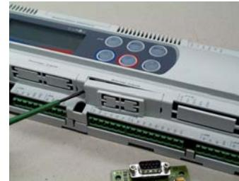
Die Modemsteckkarte wird aus der Verpackung entnommen und in die Steckverbindung auf der Reglerplatine an der Öffnung *Serial Card* eingesetzt.
