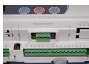
An dieser Steckkarte wird mit Hilfe eines 3-adrigen Verbindungskabels (nicht im Lieferumfang) der Schnittstellenkonverter angeschlossen.
