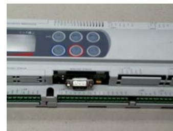
Die Abdeckung wird an den vorgegebenen Stellen ausgebrochen und wieder eingesetzt.
