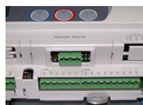
An dieser Steckkarte wird mit Hilfe eines 3-adrigen Verbindungskabels (nicht im Lieferumfang) der USB-Konverter angeschlossen.
