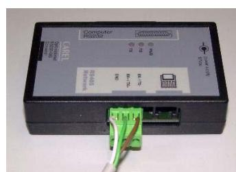
Der Anschluss des PC an den Konverter erfolgt mit Hilfe des im Lieferumfang enthaltenen Kabels.
