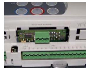
Die Abdeckung wird an den vorgegebenen Stellen ausgebrochen und wieder eingesetzt.
