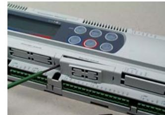
Die PC-Steckkarte wird aus der Verpackung entnommen und in die Steckverbindung auf der Reglerplatine an der Öffnung *Serial Card* eingesetzt.
