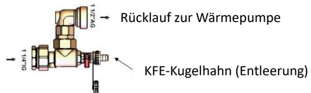
Rücklauf zur Wärmepumpe
