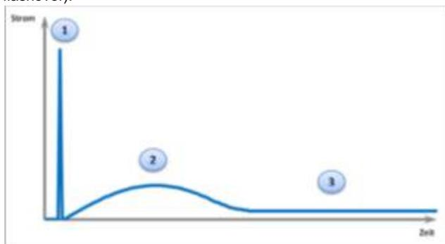
Fig.7.9: Correnti di spunto per pompe di circolazione
