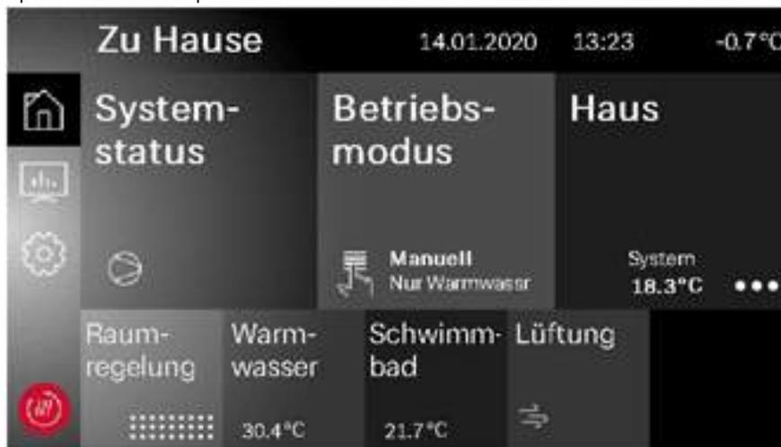
Fig.7.1: Display gestore pompa di calore con display touch (pGDx)
