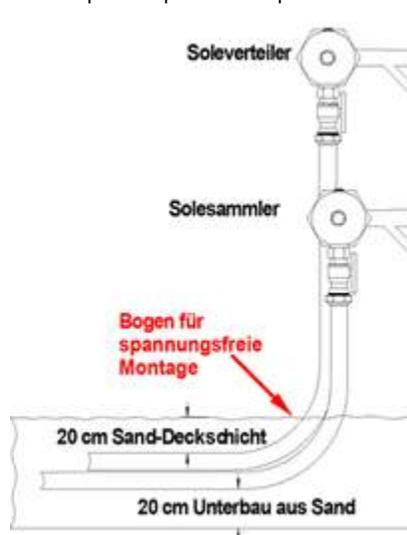
Fig. 3.6: Installazione delle tubazioni sul distributore della salamoia
